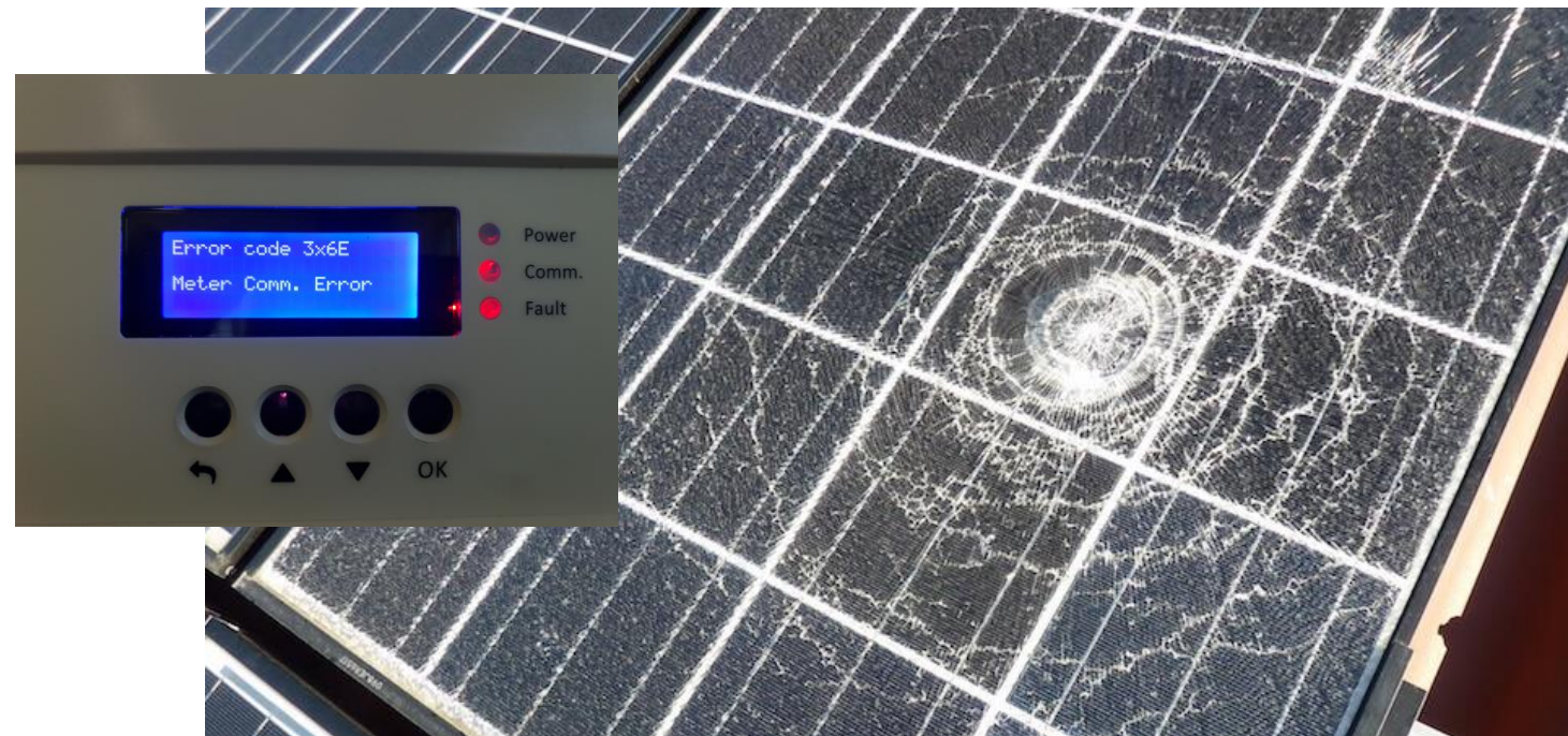
Ρωγμές στο γυαλί και οθόνη μετατροπέας
